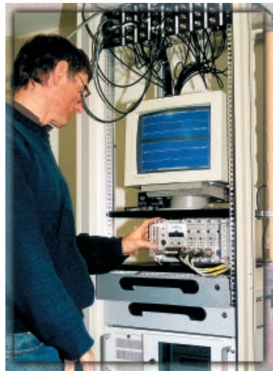
Das „Gehirn“ eines Seismometers - hier werden die Daten verarbeitet.
